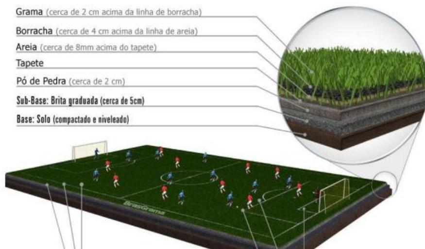
A grama deverá ter uma inclinação de 1% do meio do campo para as laterais, para haver o total escoamento da água da chuva para a drenagem. É necessário o cumprimento
